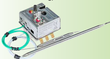
1-poliger Thermostat mit manueller Rückstellung, hoher Grenzwert, ausfallsicher, feste Einstellung, Temperaturbereich bis 320°C
